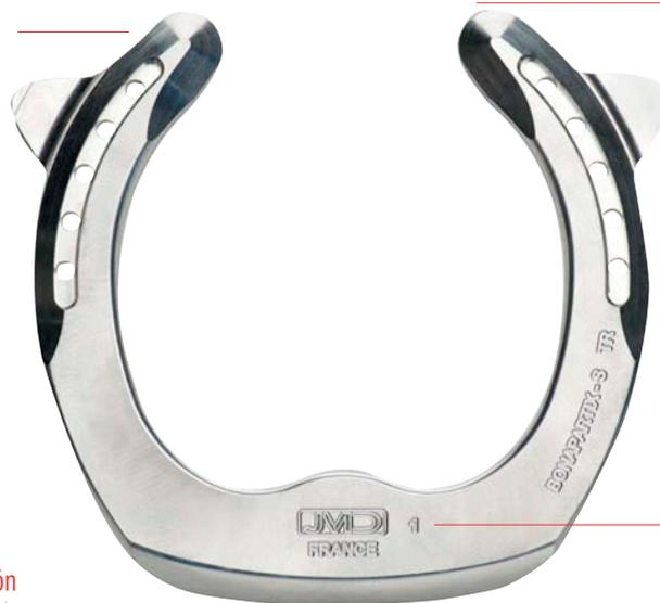
Borde externo biselado en la región posterior de la herradura para disminuir las fuerzas de palanca posterior
